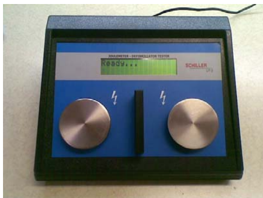
Фиг. 4.4. Разработеният джаулметър UT-3
