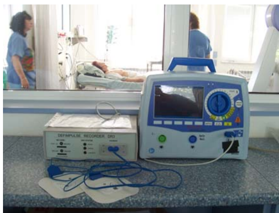
Фиг. 4.9. Системата DEFIMPULSE Recorder DR3, инсталирана в интензивното отделение на Националната Кардиологична Болница за събиране на данни по време на кардиоверсия.
