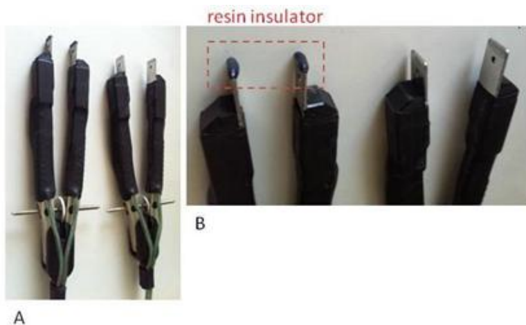
Фигура 22. Типове електроди, използвани в експерименталната част от дисертацията: (A) стандартни стоманени електроди; (B) нови електроди с изолатор в долната част.
