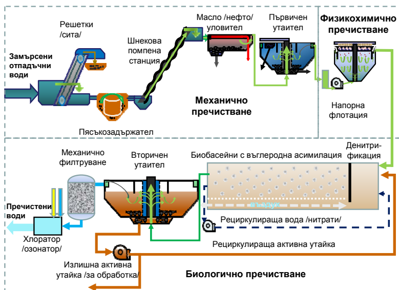
Фиг. 2. Технологична схема на процесите на пречистване на отпадъчни води
