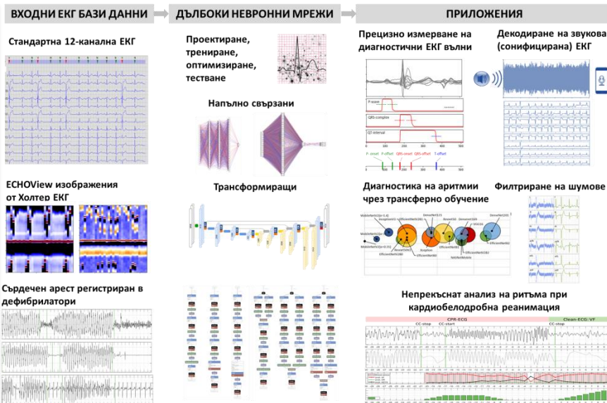
Схема за обработка на ЕКГ данни с дълбоки невронни мрежи и приложения в кардиологията.
