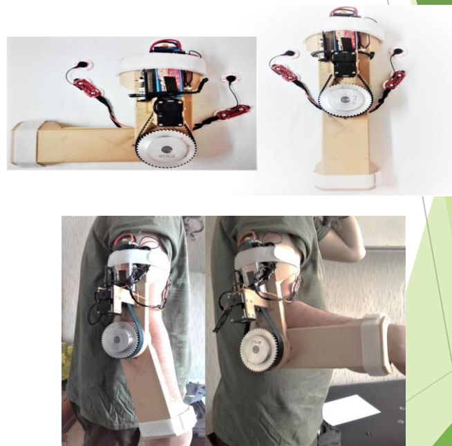
Прототип на миоелектрична ортеза за лакътна става поставена на ползвателя
